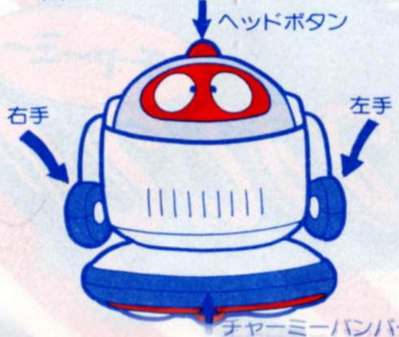
②録音するときはボクから20~30cmはなれて、4ヶ所の中で好きな場所を押しながら録音してね。録音中(押しつづけているとき)はひとみが光りますが、ひとみが消えたら録音時間の終わりです。(ウェイクアップスイッチをOFFになると録音は消えてしまいます。)
